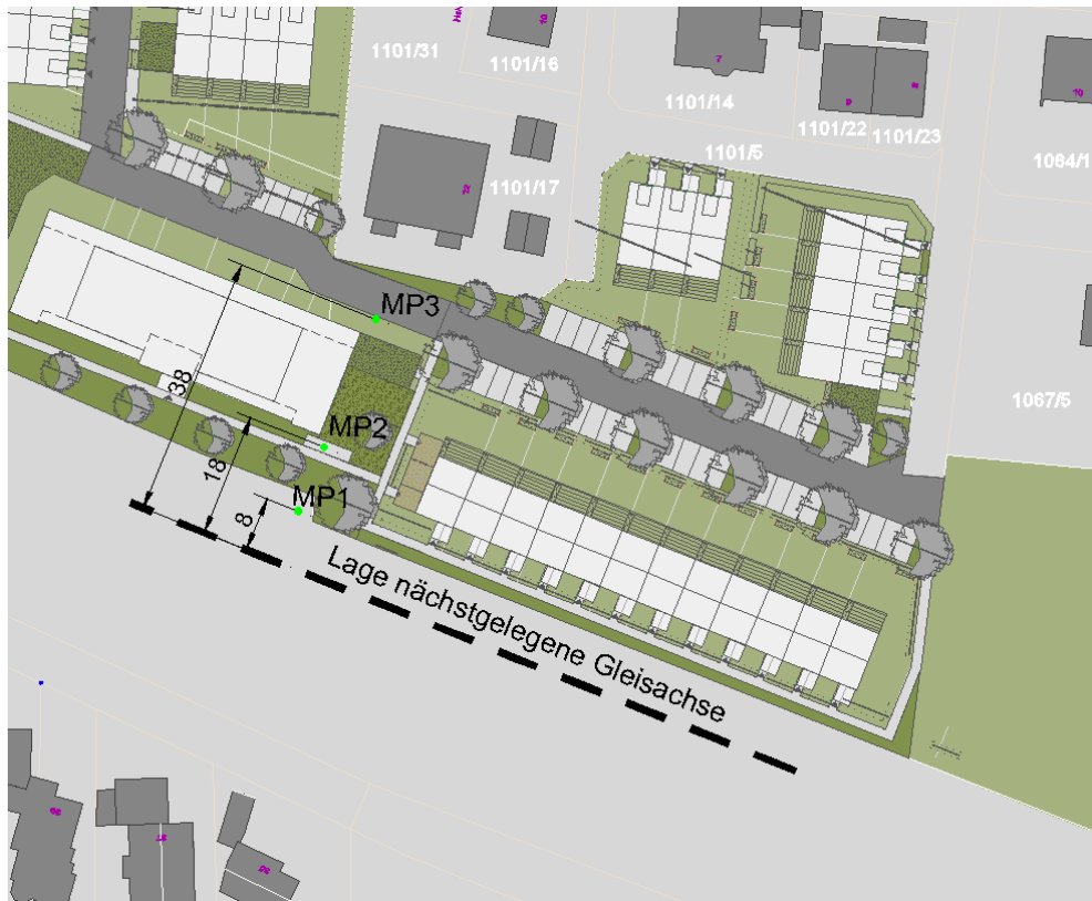
Abbildung 2: Planskizze mit den verwendeten Messpositionen (grüne Markierungen) und den Distanzen zur nächstgelegenen Gleisachse in m
