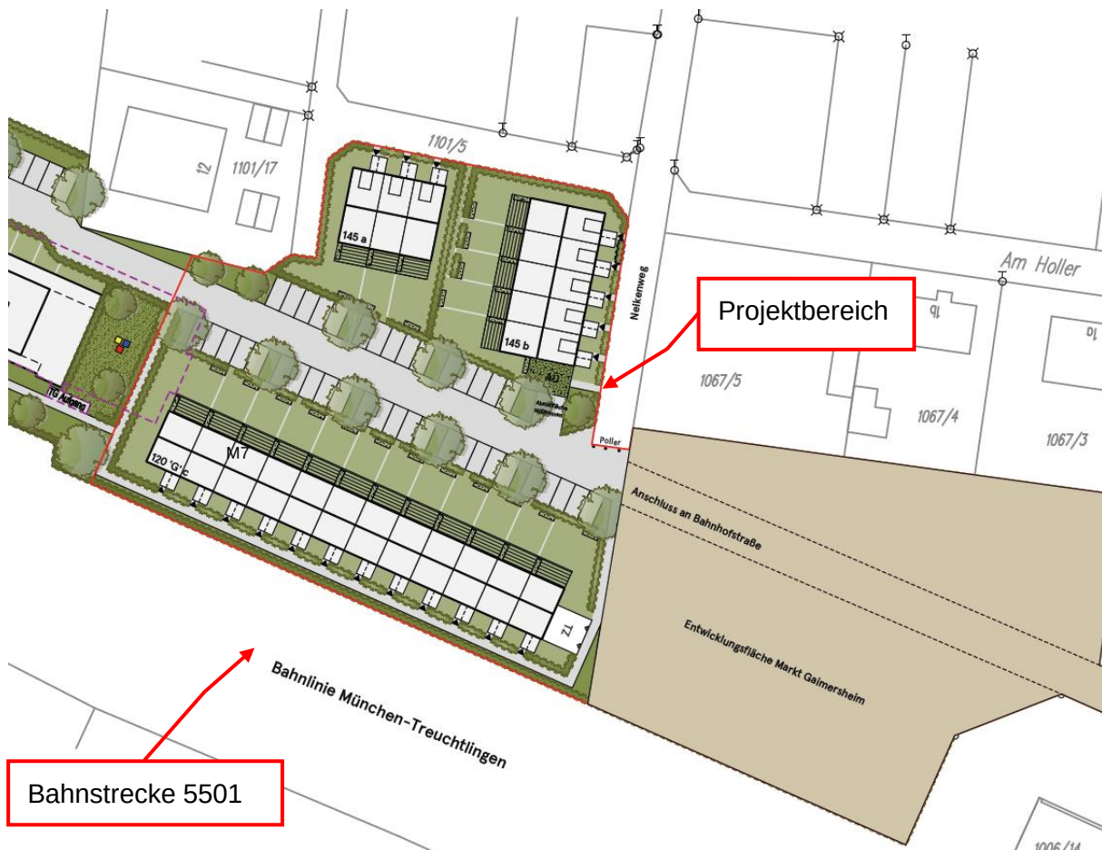
Abbildung 1: Planskizze des Bauvorhabens [7] mit Projektbereich (rot umrandet) und der angrenzenden Eisenbahnstrecke 5501
